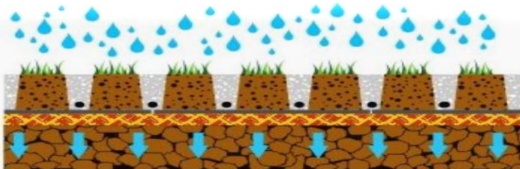
Filtración natural al subsuelo
